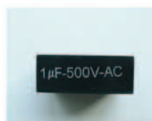
电子元件上喷印规格
